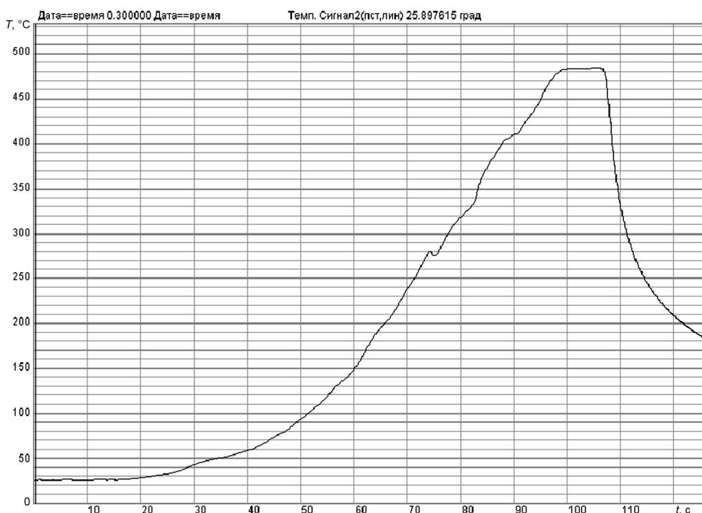
Рис. 4. Изменение температуры в стыке сварного соединения
