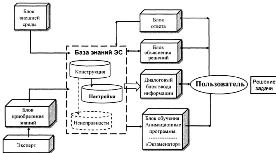
Рис. 3. Структурная схема экспертной системы
