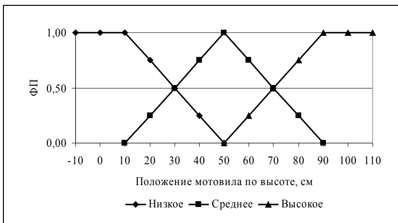
Рис.3. Функции принадлежности термов ЛП «Положение мотвила по высоте»
