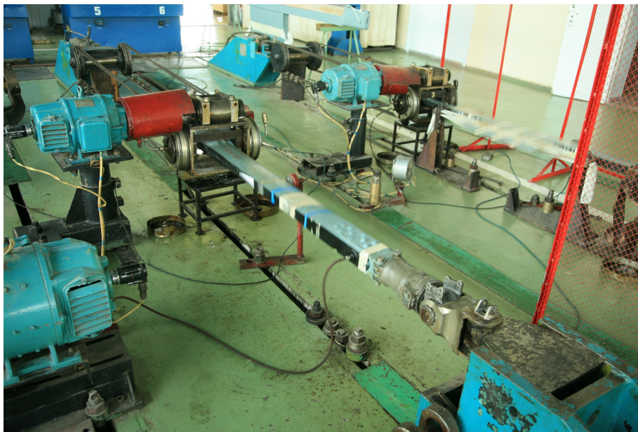
Рис.1. Стенд динамических испытаний
