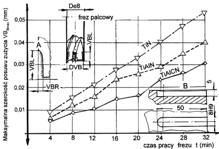
Рис.4. Максимальная ширина распространения износа при изготовлении шпоночного паза типа «С» согласно PN: А - форма изношенной кромки; В – форма шпоночного паза типа «С» согласно PN; условия эксперимента: сталь 45HNMF после закалки до 42-44 HRC; скорость резания  $V_C=88$  м/мин; подача на зуб  $f_2=0,025$  мм/зуб; горизонтальный фрезерный станок, пальцевая фреза  $D_e=8$  мм, угол наклона винтовой канавки  $55^\circ$
