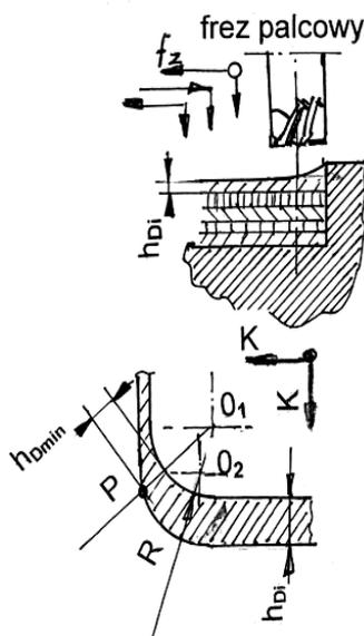
Рис.3. Поперченное сечение слоя, срезаемого режущими кромками, расположенными на переходном участке между цилиндрической и торцевой поверхностями: Р – точка минимальной толщины срезаемого слоя во время углубления фрезы в торцевую поверхность; К – направление перемещения фрезы;  $O_1, O_2$  – очередные положения центра радиуса скругления переходной кромки
