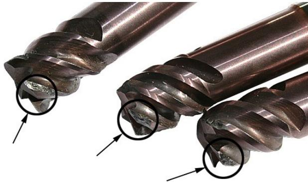
Рис.6. Примеры изношенных торцевых фрез после фрезерования шпоночного паза типа «С»; условия эксперимента аналогичны приведенным на рис.4 (материал 45HNMФ; твердость 42-44 HRC;  $V_c = 88$  м/мин;  $f_1 = 0,025$  мм/зуб;  $D_{e8} = 8$  мм)
