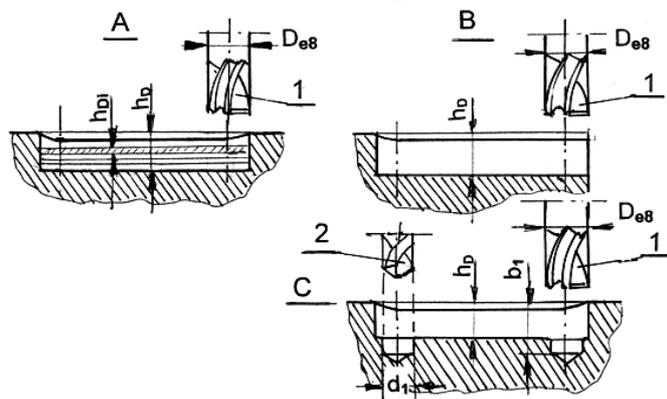
Рис.1. Способы изготовления пазов пальцевой фрезой: А – фрезерование закрытого паза методом возвратно-поступательного движения, В – фрезерование торца вала на полную глубину, С – фрезерование глухого паза после предварительно просверленных
