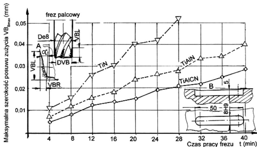
Рис.2. Максимальная ширина фаски износа фрезы с покрытиями из  $TiN$ ,  $TiAlN$  и  $TiAlCN$ : А – форма изношенной кромки фрезы; В – форма шлицевого паза типа «А» согласно PN. Условия эксперимента: заготовка – сталь 4SHNMF (40-44 HRC); скорость
