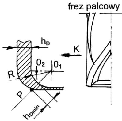
Рис.5. Поперечное сечение слоя, срезанного режущими кромками фрезы, расположенными на переходном участке между цилиндрической и торцевой поверхностями; P – критическая точка с наименьшей толщиной срезанного слоя; K – направление перемещения фрезы; R – радиус переходного участка;  $O_1, O_2$  – текущие положения центров радиуса переходного участка
