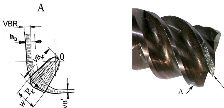
Рис.7. Износ торцевой фрезы на переходном участке – видна точка P (см.рис.3)
