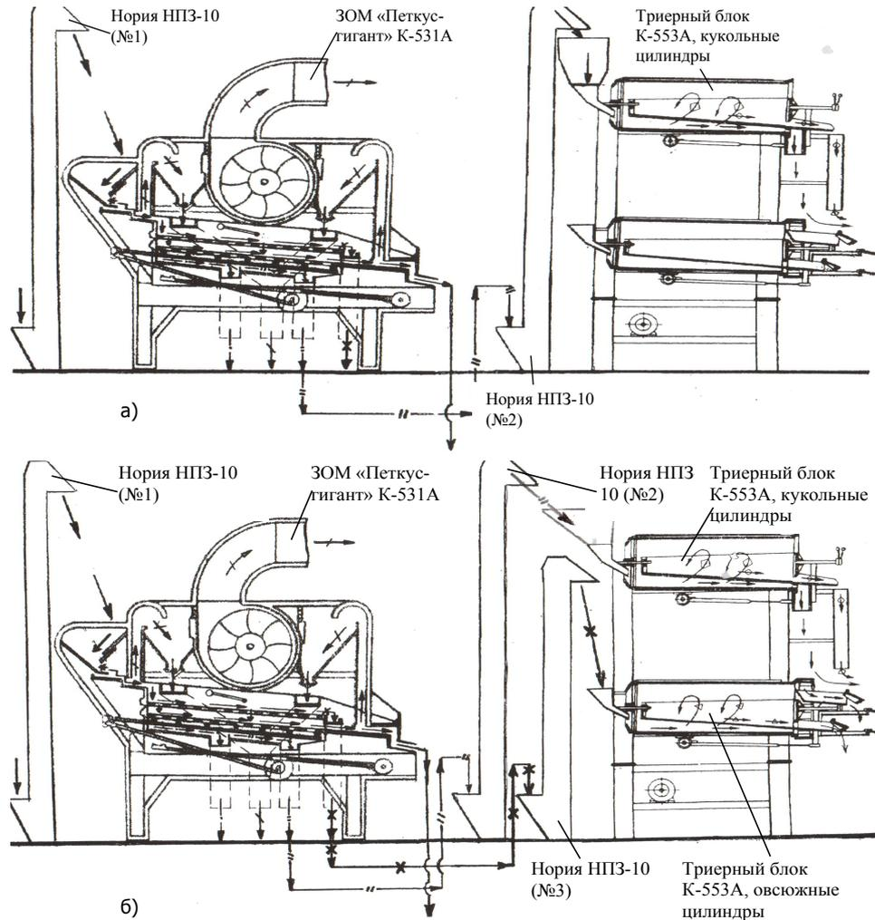
Рис. 3. Функциональные схемы: а – схема №2; б– схема №3; поток обрабатываемой культуры →; крупные примеси ↗; легкие примеси ↘; мелкое зерно и фуражные отходы ↙; мелкие примеси →; очищенное зерно ЗОМ) →; очищенное зерно (тр. блок, овс. цил.) →, длинные примеси (тр. блок, овс. цил.) ↗, мелкое очищенное зерно (тр. блок, кук. цил) →, короткие примеси (тр. блок, кук. цил) ↘
