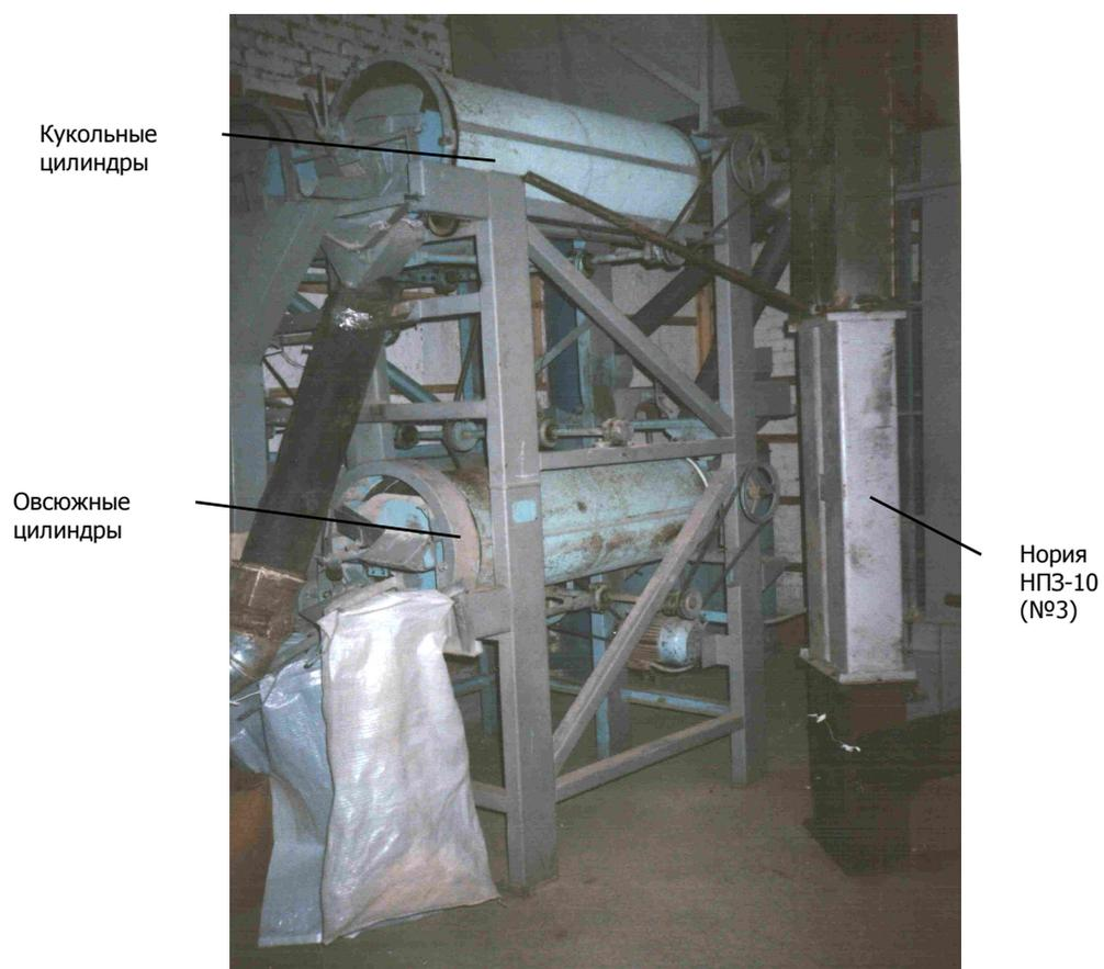
Рис.2. Общий вид переоборудованного триерного блока фирмы «Петкус» К 553А
