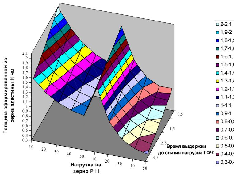
Рис. 2. Поверхность отклика толщины зерновой пластины  $H$  в зависимости от нагрузки  $P$  при выдержке под нагрузкой  $T$  зерна озимой пшеницы (слева поверхность для зерна влажностью 40%; справа – для зерна влажностью 47%)
