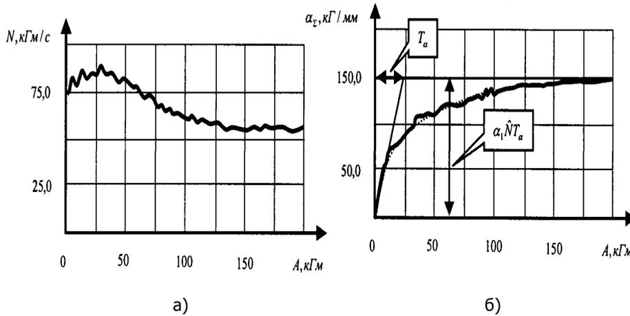
Рис.4. Пример упрощённого способа оценивания параметров ядер интегрального оператора: а – фазовая траектория работы-мощности; б – функция изменения суммарной жёсткости по работе
