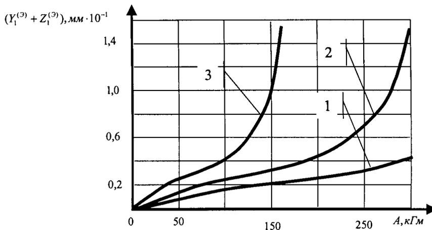
Рис.1. Смещение точки равновесия системы в направлении, нормальном к оси вращения заготовки, при её эволюционных преобразованиях:
