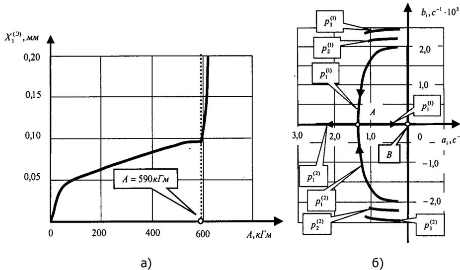
Рис.3. Эволюционные траектории смещения точки равновесия системы в направлении  $X_1$  (а) и корней характеристического полинома (б) для системы (8)
