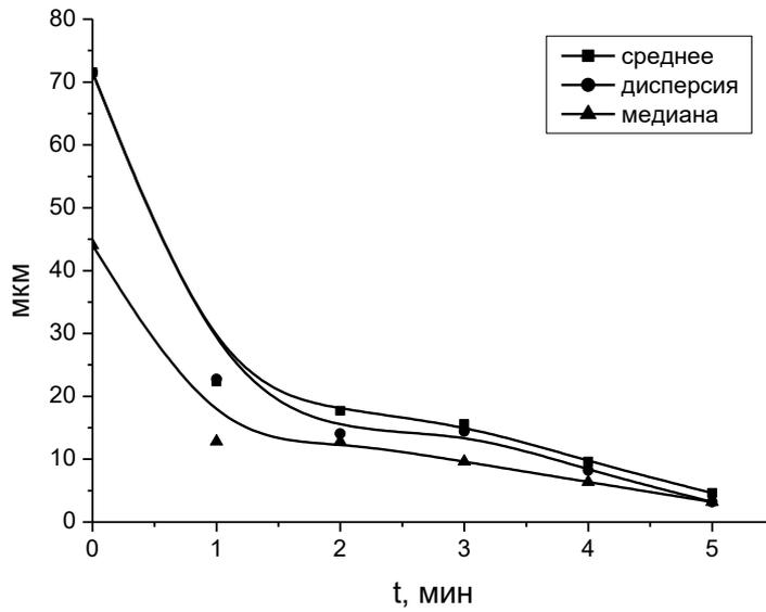
Рис.5. Зависимости среднего размера частиц продуктов измельчения, дисперсии и медианы от времени помола
