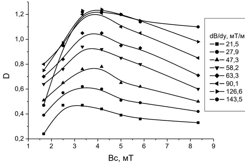
Рис.3. Зависимость оптической плотности  $D$  магнитовибрирующего слоя от индукции  $B_c$  постоянного и градиента индукции  $\frac{\partial B}{\partial y}$  переменного магнитных полей
