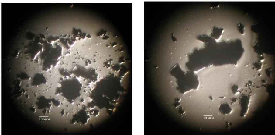
Рис.2. Форма частиц исходного сплава Nd-Fe-B
