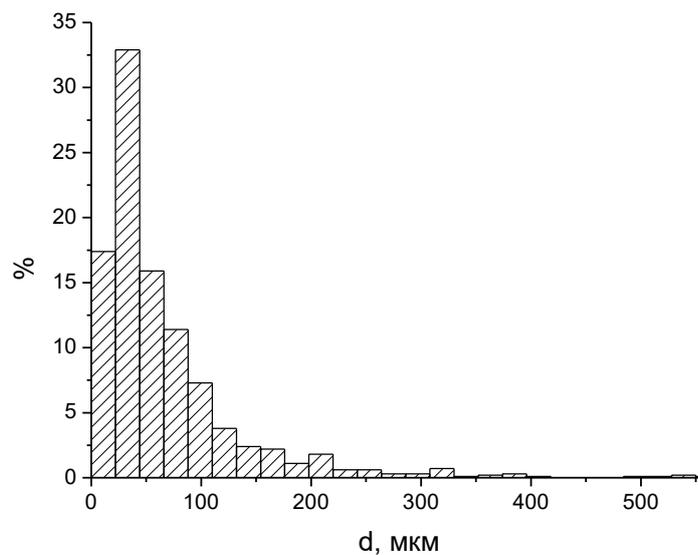
Рис.1. Гистограмма распределения частиц сплава Nd-Fe-B по размерам
