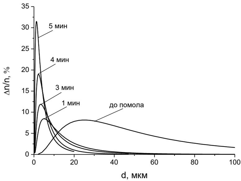
Рис.4. Зависимости относительного содержания фракций сплава  $\Delta n/n$  от размера  $d$  фракции
