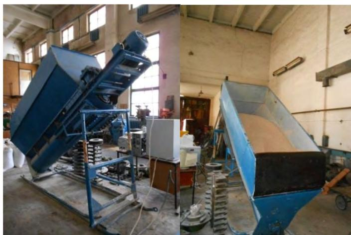
Рис. 1. Общий вид наклонного одношнекового порционного смесителя
