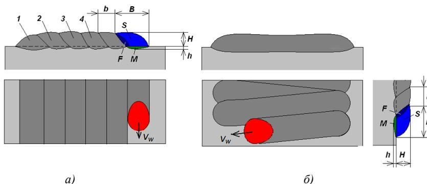
Рис. 4. Характерные размеры при наплавке покрытий ниточными швами (а) и с поперечными колебаниями (б): 1...4 — номера валиков,  $V_w$  — направление движения горелки;  $B$  — ширина ванны;  $b$  — шаг дуги;  $h$  — глубина проплавления;  $H$  — высота наплавки;  $S, F, M$  — площади наплавки, оплавления предыдущего валика и расплава подложки
