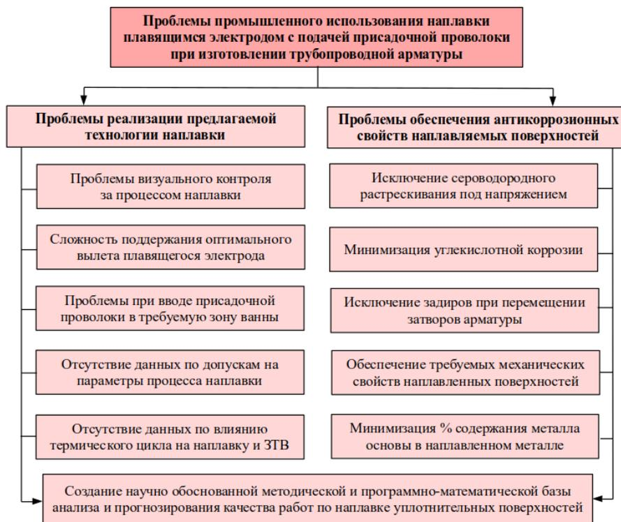
Рис. 3. Проблемы промышленного использования наплавки плавящимся электродом с дополнительной присадочной проволокой
