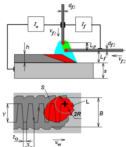
Рис. 2. Схема процесса наплавки плавящимся электродом с подачей присадочной проволоки и поперечными колебаниями горелки:  $I_o$ ,  $I_f$  — токи основной и дополнительной дуги;  $R$  — радиус факела дуги;  $s$  — толщина подложки;  $d_f$ ,  $v_f$  — диаметр и скорость подачи проволоки;  $Y$ ,  $t_o$ ,  $\tau$  — параметры поперечных колебаний;  $L$ ,  $S$  — расплав и наплавленный слой
