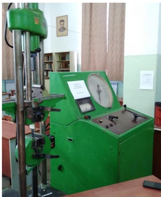
Рис. 3. Разрывная машина
