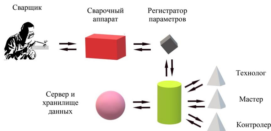
Рис. 1. Информационные потоки мониторинга процессов сварки
