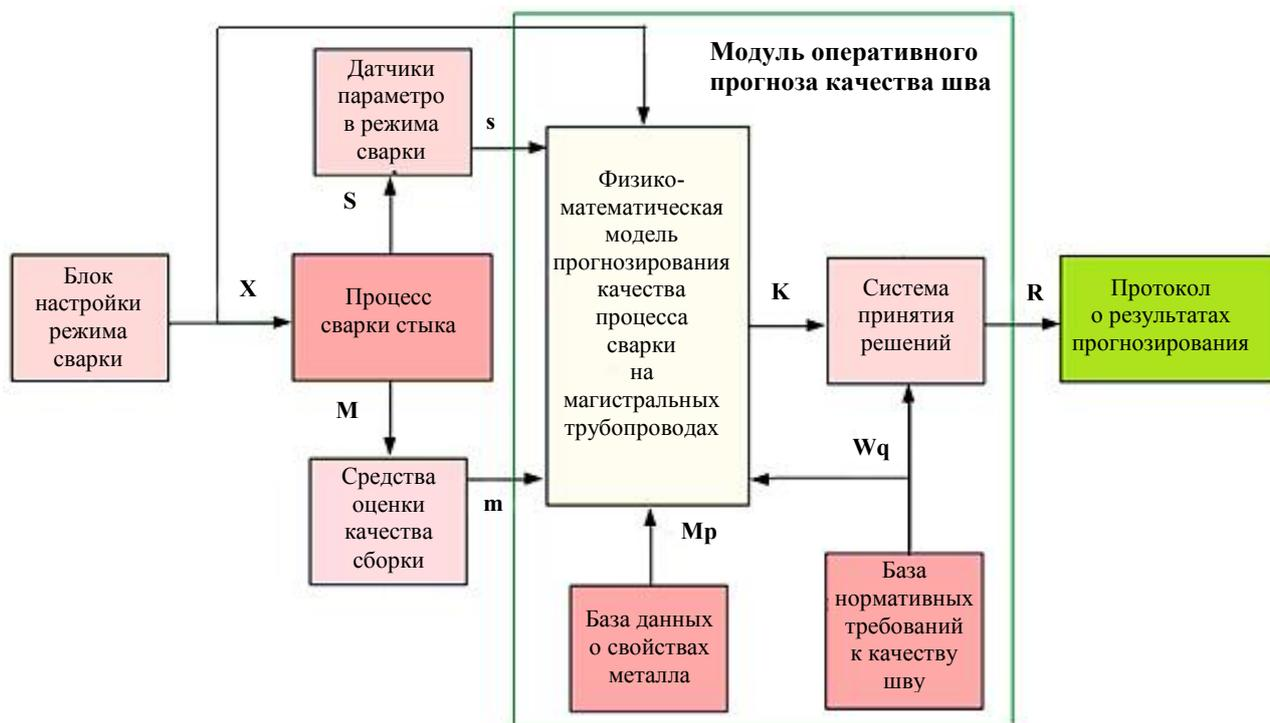
Рис. 4. Структура системы прогнозирования результатов процесса сварки:
