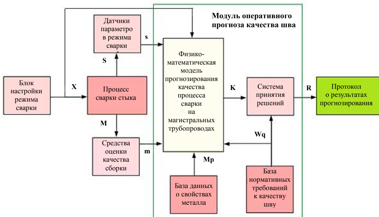
Рис. 4. Структура системы прогнозирования результатов процесса сварки:
