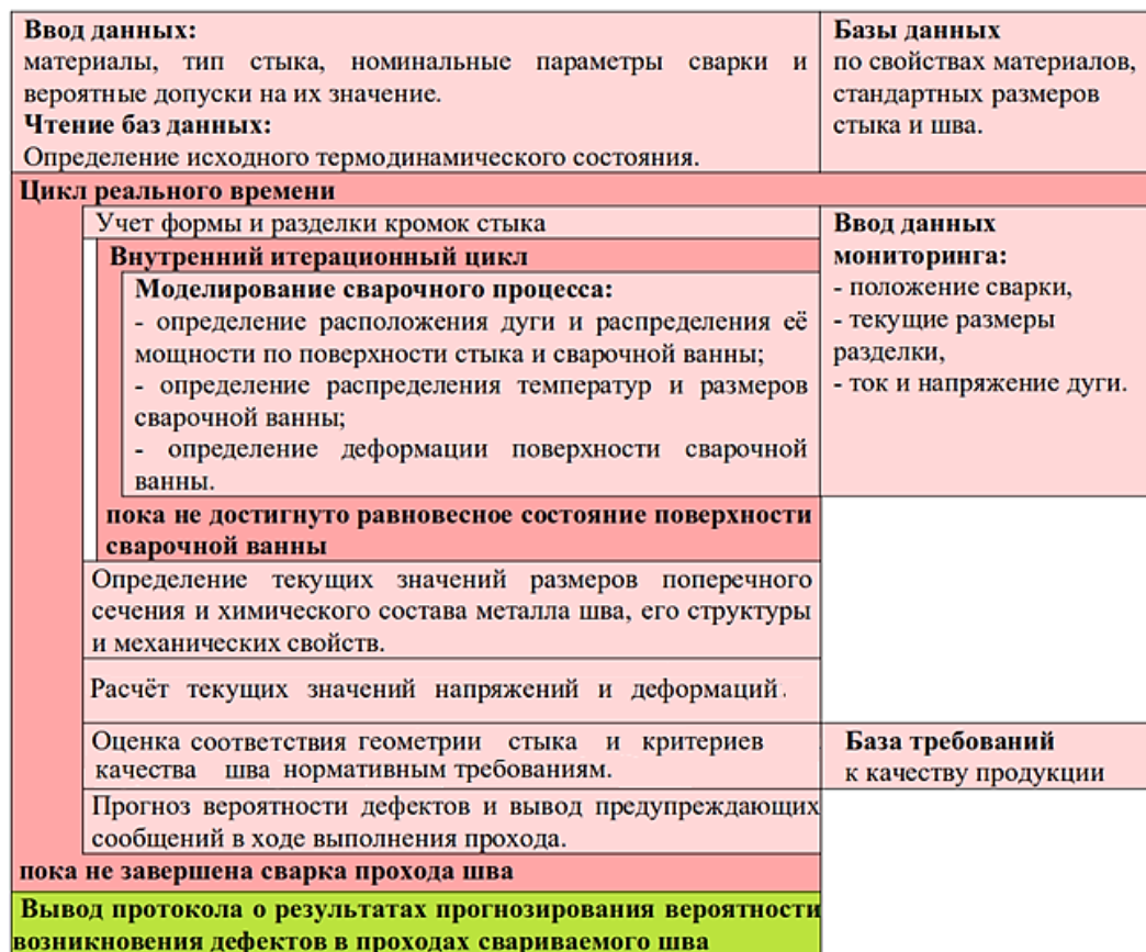
Рис. 3. Структура физико-математической модели для прогнозирования результатов процессов сварки в составе интеллектуального модуля
