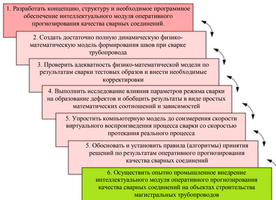
Рис. 5. Содержание и последовательность работ по созданию и внедрению интеллектуального модуля оперативного прогнозирования качества сварки
