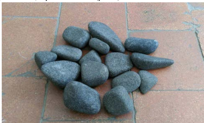
Рис. 1. Бой кругов 40 \times 80 , зернистость 25
