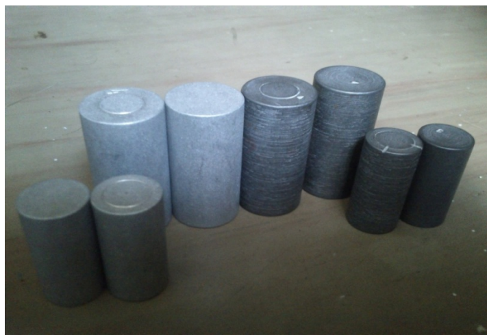
Рис. 3. Обрабатываемые детали из алюминия Д16 и стали 30ГСА
