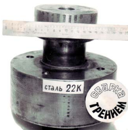
Рис. 4. Сварная модель из стали 22К с диаметром патрубка 80 мм
