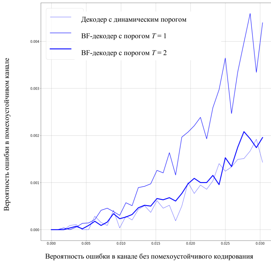
Рис. 2. График корректирующей способности декодеров для LDPC-кодов, заданных матрицей H_2
