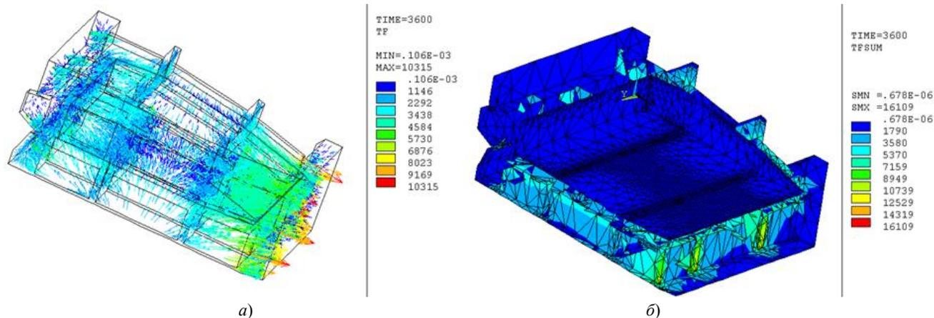
Рис. 3. Тепловые потоки (а) и суммарный нагрев (б) приспособления с отсеком
