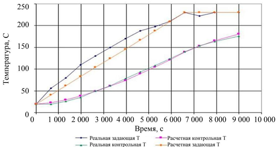
Рис. 2. Зависимости от времени расчетных и измеренных температур в контрольной и задающей точках
