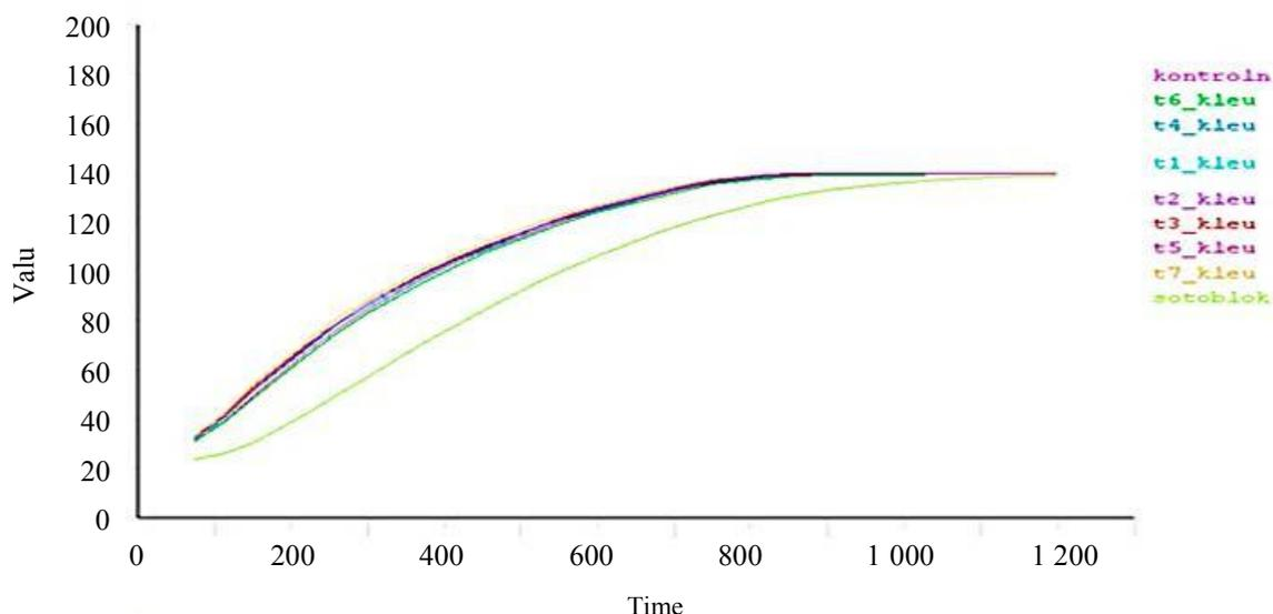
Рис. 5. Зависимости температуры от времени в характерных точках клеевых зон и в блоке (зеленая линия) для технологического режима, включающего два переключения при задающих температурах 160 и 140 °С
