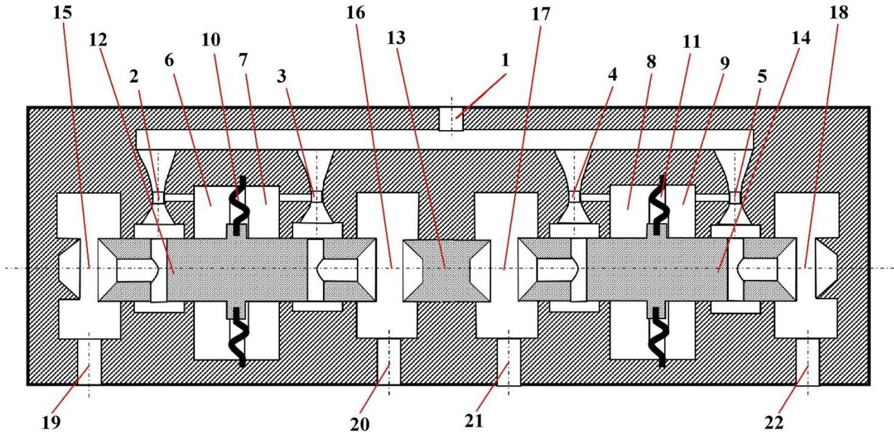
Рис. 5. Четырехпоточный делитель с чувствительными элементами типа трубка Вентури
