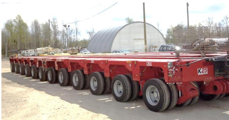
Рис. 2. Два соединенных 6-осных самоходных модуля InterCombi K25 компании Kamag (Германия)
