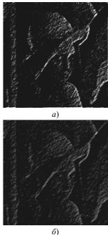
Рис. 4. Результаты обработки методом сплайн-дифференцирования тестового изображения, подвергшегося воздействию шума: «битые пиксели» (a); «соль-перец» ( $\delta$ )
