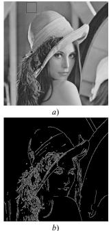
Рис. 1. Тестовое изображение: исходное (а); результат обработки тестового изображения детектором границ Canny (b)
