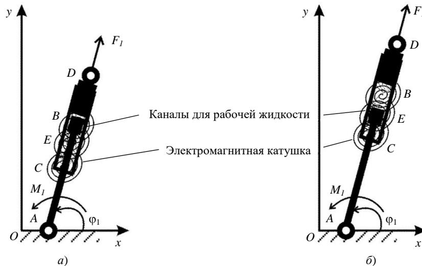
Рис. 1. Конструкция звена переменной длины с магнитно-реологической жидкостью:
