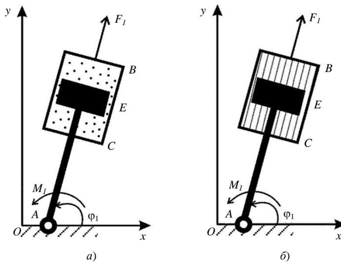
Рис. 2. Частицы магнитно-реологической жидкости в цилиндрической части звена: *a* — магнитные частицы расположены случайным образом без приложения внешнего магнитного поля; *b* — выстроившиеся цепочки ориентированных магнитных частиц вдоль силовых линий под действием внешнего магнитного поля (рисунок авторов)
