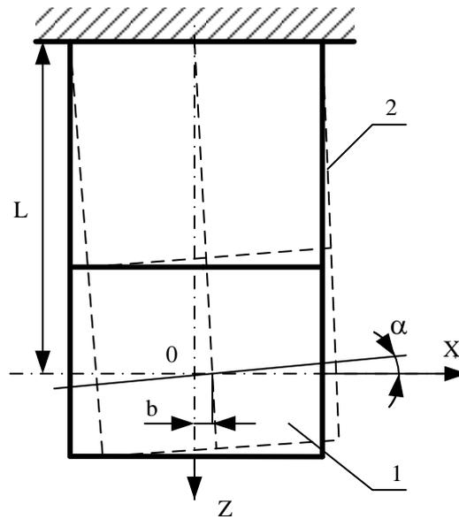
Рис. 2. Повороты корпуса упрочнителя в процессе колебаний
