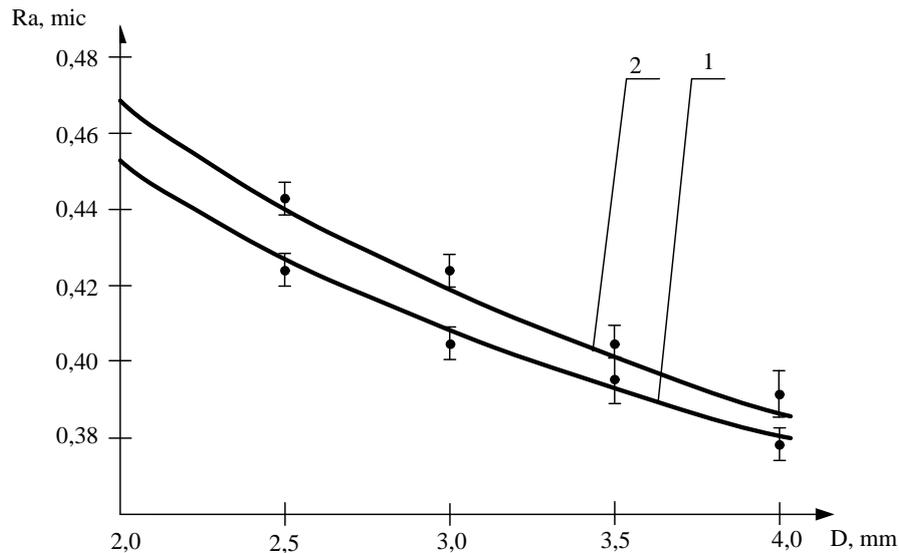
Рис. 3. Зависимость шероховатости поверхности от радиуса индентора:
