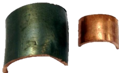
Рис. 6. Образцы для изучения кинетики окисления; показаны внешние поверхности эталонных образцов чистой меди (справа) и меди с покрытием Mo-Ni-Cr (слева), подготовленные для проведения экспериментов
