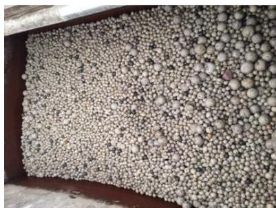
Рис. 3. Вид рабочей среды (фарфоровых шаров)
