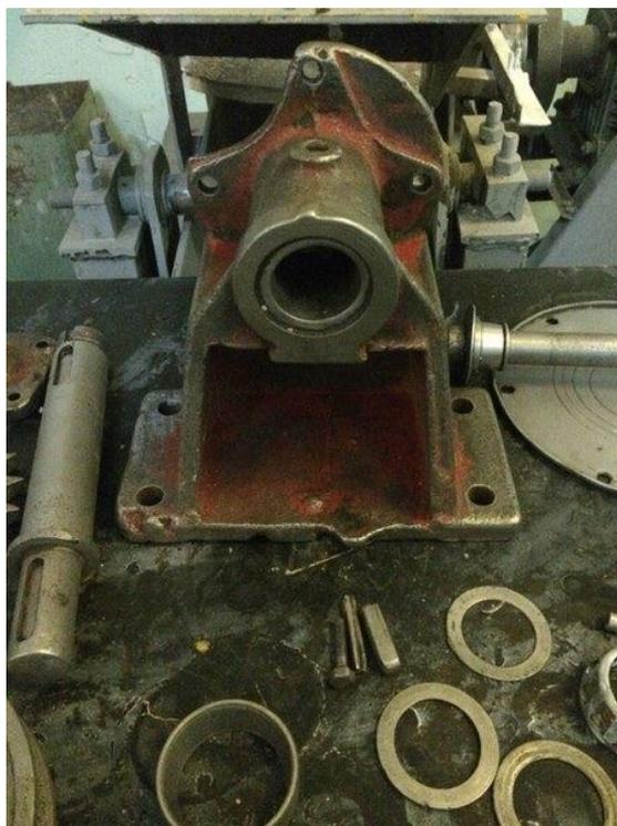
Рис. 2. Внешний вид поверхности деталей после второй моечно-очистной операции
