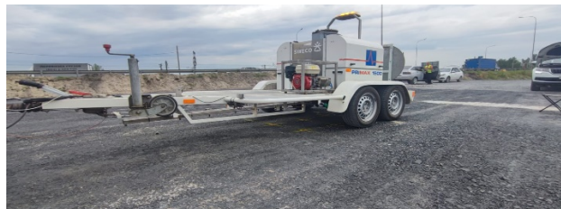
Рис. 4. Установка ударного нагружения для регистрации вертикальных перемещений на слое из органоминеральной смеси
