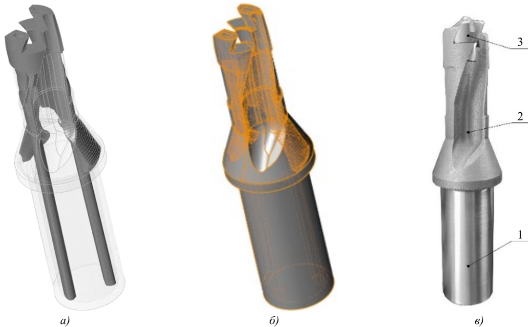
Рис. 1. Корпусное сверло: а — модель топологически оптимизированной части корпуса сверла с посадочной головкой и криволинейными каналами охлаждения корпуса; б — модель ТО корпуса сверла с тонкостенной оболочкой, формирующей стружечные канавки и хвостовик; в — физический образец ТО металл-композитного корпусного сверла (полость после ТО заполнена МПКМ), полученный по SLM технологии: 1 — обработанный точением металл-композитный хвостовик; 2 — стружечные канавки; 3 — режущая головка корпусного сверла
