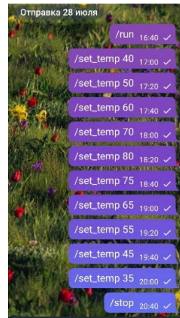
Рис. 5. Температурный режим в экспериментах: а — график изменения температуры; б — соответствующая последовательность команд телеграм-бота
