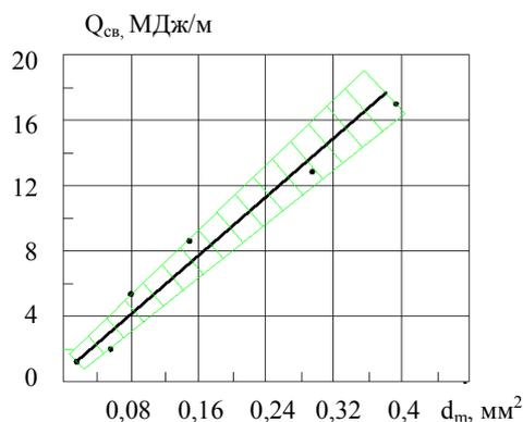
Рис. 1. Влияние погонной энергии при сварке  $Q_{св}$  на средний условный диаметр зерна  $d_m$  металла ЗТВ
