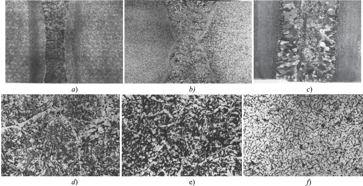
Рис. 4. Макростроение сварного соединения, выполненного способом: АСТ (а); АСФ (б); ЭШС,  $\times 100$ ; микроструктура сварного соединения, выполненного АСТ (с); металл сварного шва (d); металл ЗТВ (е); основной металл,  $\times 500$  (f)
