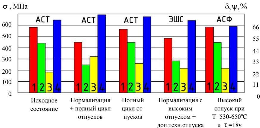
Рис. 5. Влияние способа сварки и термической обработки на механические свойства металла шва: 1 — временное сопротивление разрыву σ<sub>в</sub>; 2 — условный предел текучести σ<sub>0,2</sub>; 3 — относительное удлинение δ; 4 — относительное сужение ψ
