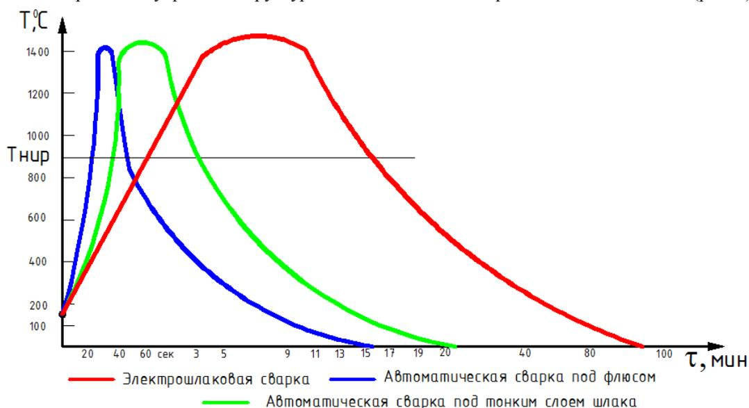
Рис. 2. Влияние способа сварки на параметры термического цикла металла ЗТВ
