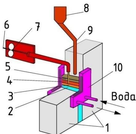
Рис. 3. Принципиальная схема способа АСТ: 1 — свариваемые детали; 2 — металл сварного шва; 3 — сварочная ванна; 4 — жидкий шлак; 5 — слой флюса; 6 — сварочная проволока; 7 — механизм подачи проволоки; 8 — дозатор флюса; 9 — подвод флюса в зону сварки; 10 — медный водоохлаждаемый ползун
