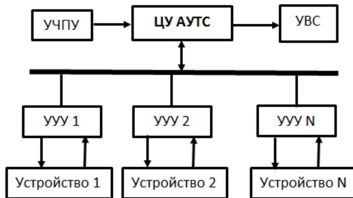
Рис. 1. Структура системы АУТС станка: ЦУ АУТС — центральный узел автономного управления техническим состоянием устройств станка; УВС — управление внешними службами; УУУ — узел управления устройством станка
