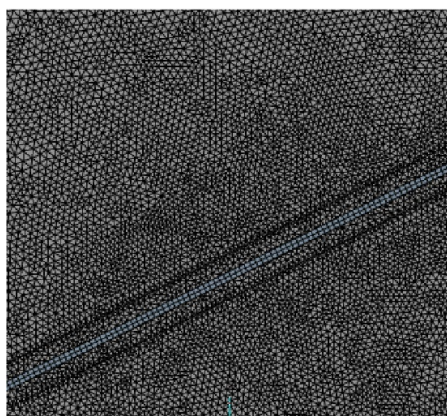
Рис. 3. Изображение построенной сетки на модели кремниевой пластины с элементом тепловой памяти в диэлектрическом кармане шириной 100 мкм
