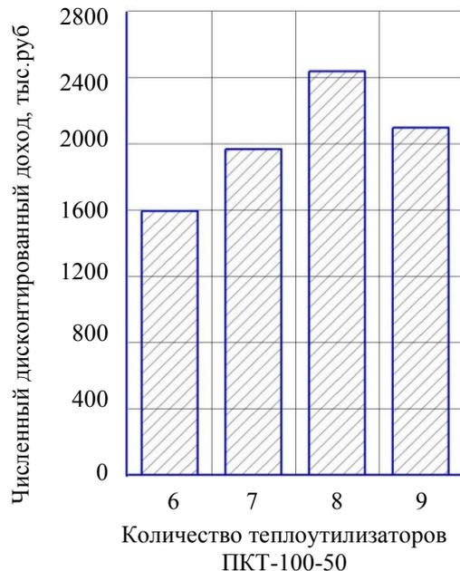
Рис. 4. Изменение чистого дисконтированного дохода от количества используемых утилизаторов
