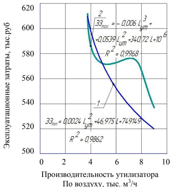
Рис. 3. Зависимость эксплуатационных затрат от производительности теплоутилизаторов:
