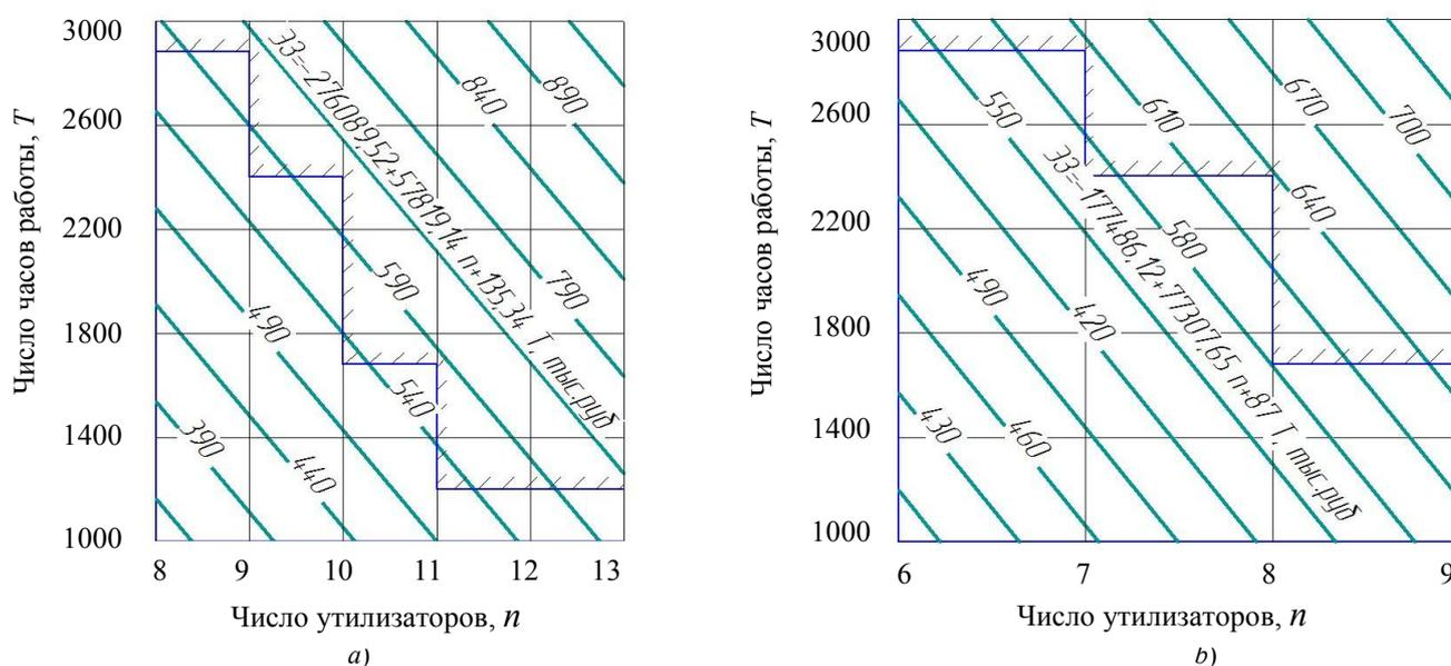
Рис. 2. Контурные графики целевых функций эксплуатационных затрат теплоутилизаторов: ПКТ-80-50 (а); ПКТ-100-50 (б)
