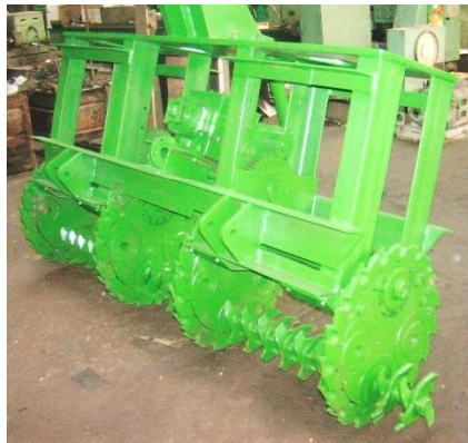
Рис. 3. Роторно-фрезерный почвенно-мелиоративный плуг с активной редукторной стойкой привода, 2008 г.
