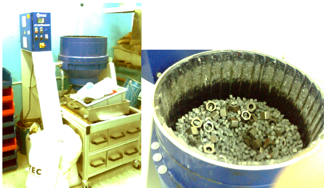
Рис. 2. Галтовочный барабан CF 1×18 В. Слева — общий вид, справа — рабочая камера, заполненная обрабатываемой средой и деталями
