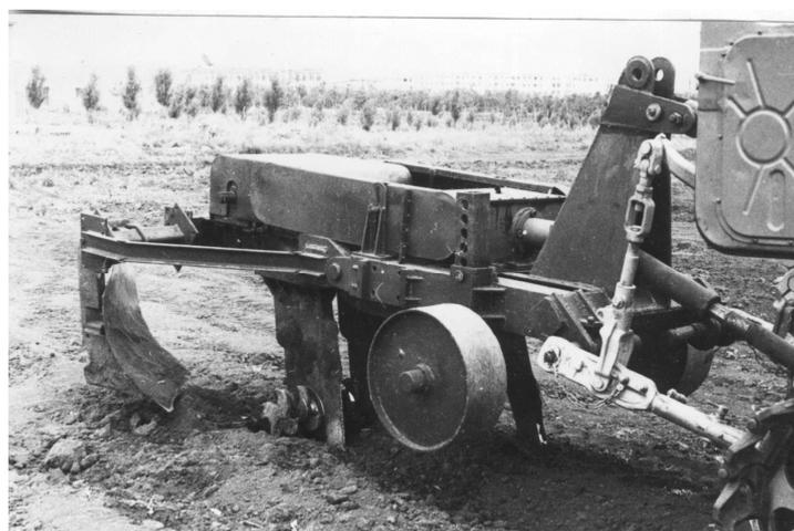
Рис. 3. Устройство для почвенно-мелиоративной ротационной фрезерной обработки почвы ПМС-70 в процессе погружения в почву
