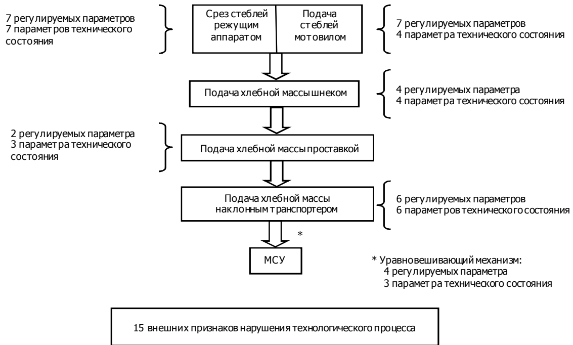
Рис. 1. Структура предметной области «технологическая регулировка жатвенной части»: процессы, параметры, показатели качества работы; МСУ — молотильно-сепарирующее устройство
