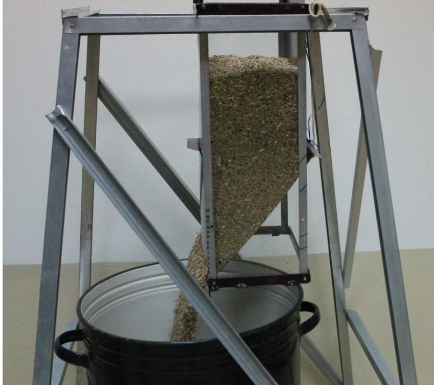
Рис. 3. Бункер для экспериментального исследования истечения зернового материала
