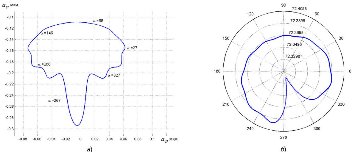
Рис. 3. Результаты моделирования: а – движение ротора в плоскости  $a_1a_2$  в контакте **a**; б – зависимость частоты вращения ротора от его угла поворота
