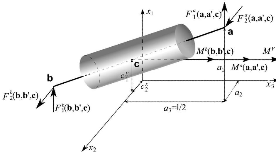
Рис. 2. Обобщенная роторная система
