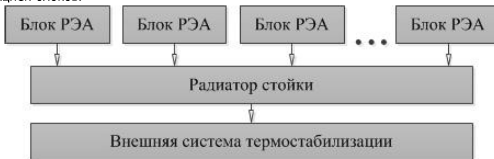
Рис. 1. Структурная схема отвода тепла от стойки
