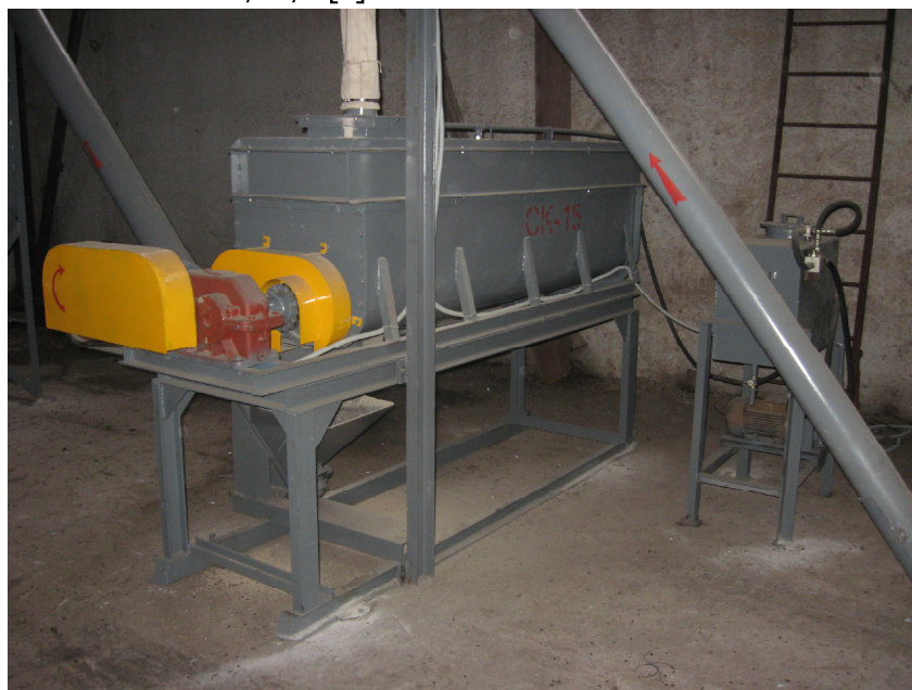
Рис. 3. Технологический модуль ввода жидких обогащающих добавок и лекарственных (витаминных) эмульсий
