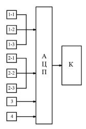
Рис.3. Блок-схема КИК: 1-1; 1-2; 1-3 — датчики измерения фазового напряжения электрического тока на входе индуктора  $U_{\phi}$  в B; 2-1; 2-2; 2-3 — датчики измерения фазовой силы электрического тока на входе индуктора  $I_{\phi}$  в A; 3 — датчик измерения частоты колебания электрического тока f в  $\Gamma$ ц; 4 — датчик измерения магнитной индукции  $B_m$  в мТл; AЦП — аналого-цифровой преобразователь; K — компьютер
