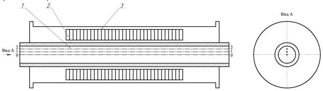
Рис. 1. Схема индуктора: 1 — рабочая камера; 2 — обмотки; 3 — корпус
