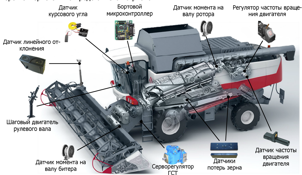
Рис. 6. Размещение датчиков и исполнительных устройств ММСЗК PCM-181 «Torum-740»
