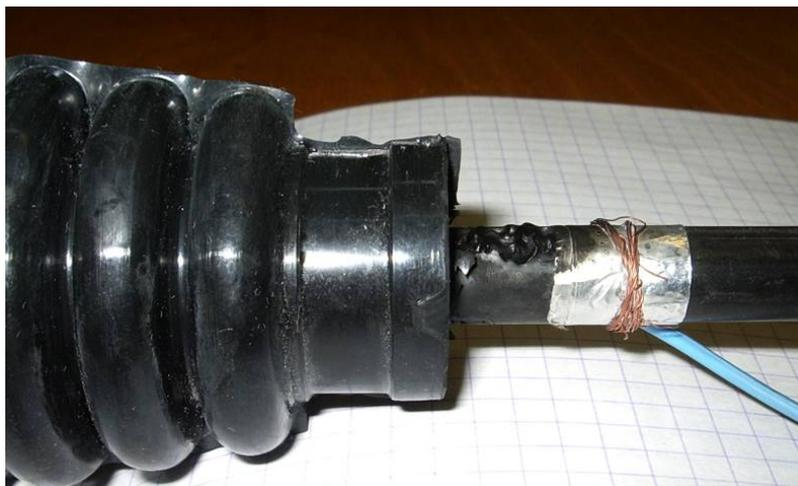
Рис.2. Разрушение полиэтиленовой оболочки кабеля
