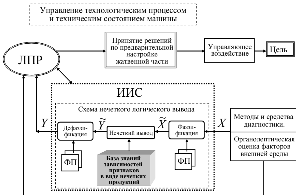
Рис.2. Структурная схема метода организации информационной поддержки принятия решений при предварительной настройке машины
