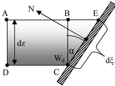
Рис. 2. Контакт элементарного слоя с боковой поверхностью бункера
