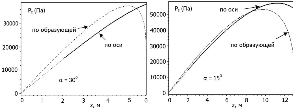
Рис. 4. Вертикальное давление в щелевом бункере вдоль осевой и образующей боковую поверхность линий при различных углах наклона стенки бункера  $\alpha$ :  $\gamma = 800 \text{ кг / м}^3$ ;  $\psi = 16^\circ$ ;  $\varphi = 20^\circ$ ;  $\chi = 30^\circ$ ;  $W = 3,5 \text{ м}$
