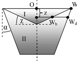
Рис. 3. Разделение пространства щелевого бункера на области
