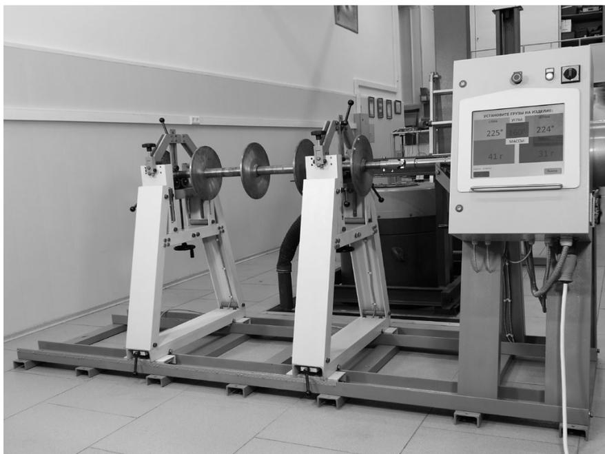
Рис. 3. Балансировочный станок нового поколения, созданный в ДГТУ для ООО «Новатор-Плюс» (г. Ростов-на-Дону)
