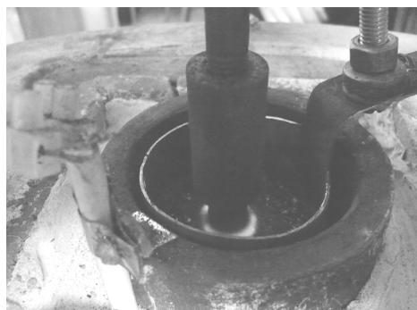
Рис. 2. Зона горения угольного порошка
