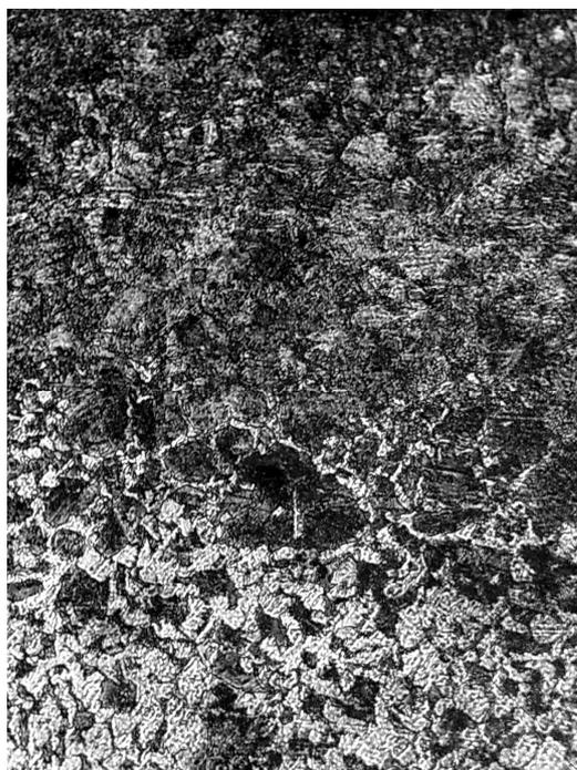
Рис. 3. Микроструктура поверхностного слоя стали 20 после микродуговой цементации
