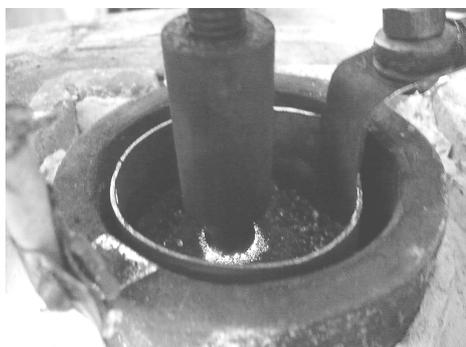
Рис. 1. Зона микродуг вокруг образца
