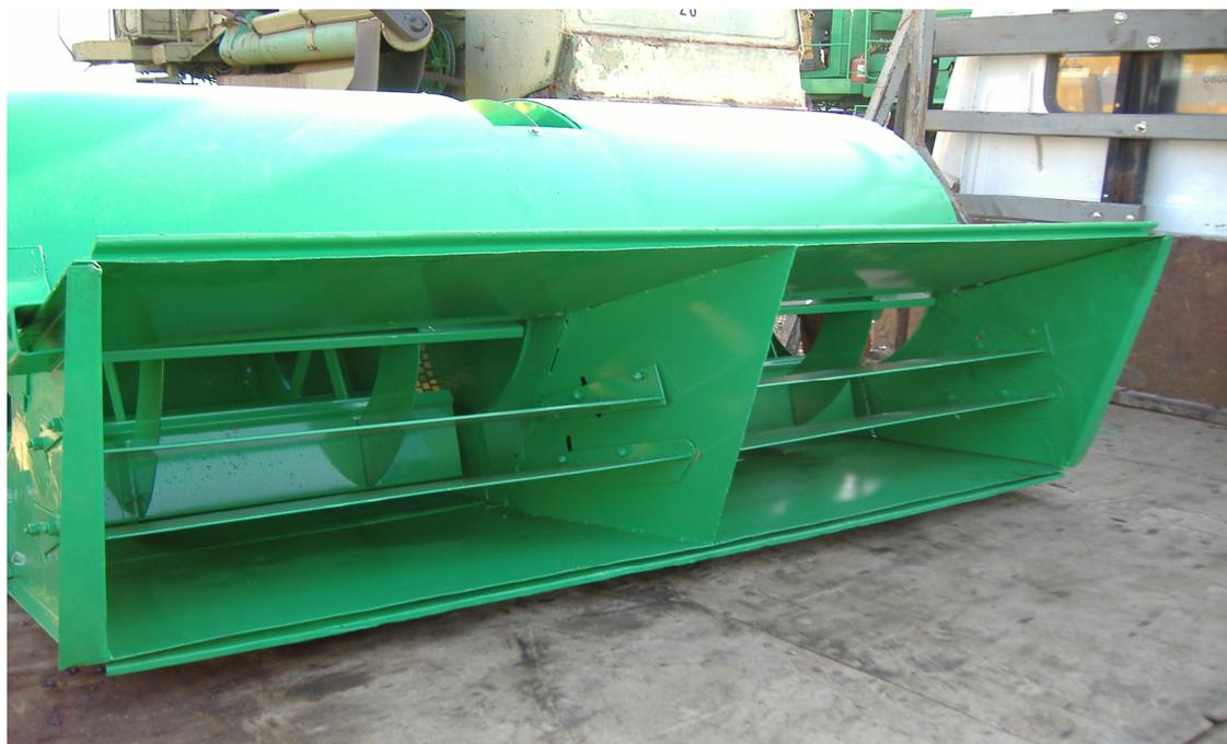
Рис. 3. Общий вид двухсекционного вентилятора
