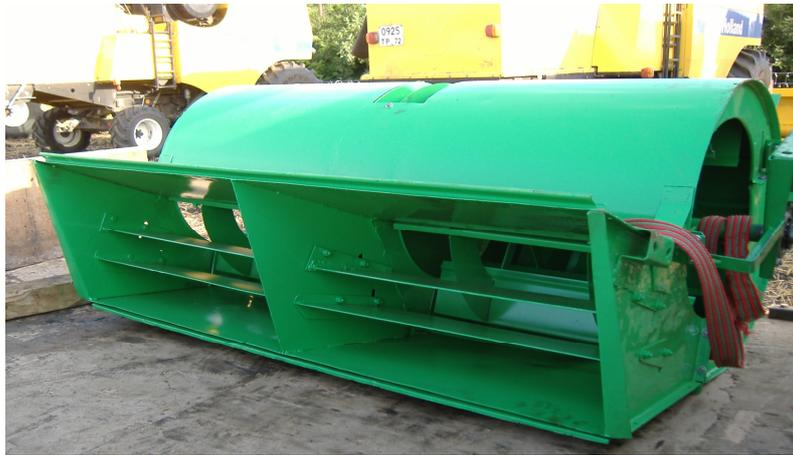
Рис.2. Общий вид двухсекционного вентилятора
