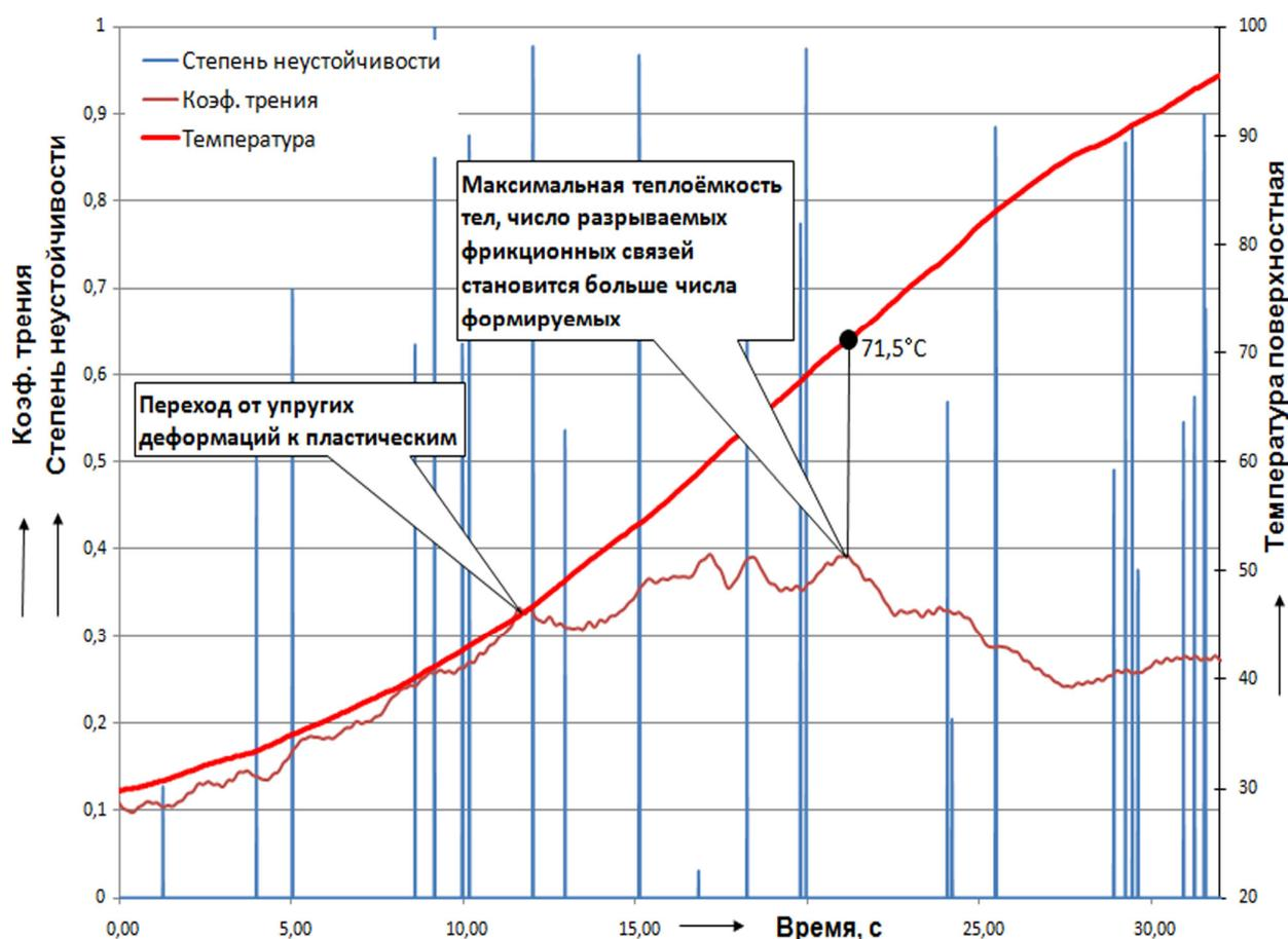
Рис.1. Зависимость коэффициента трения от поверхностной температуры как функции времени испытаний
