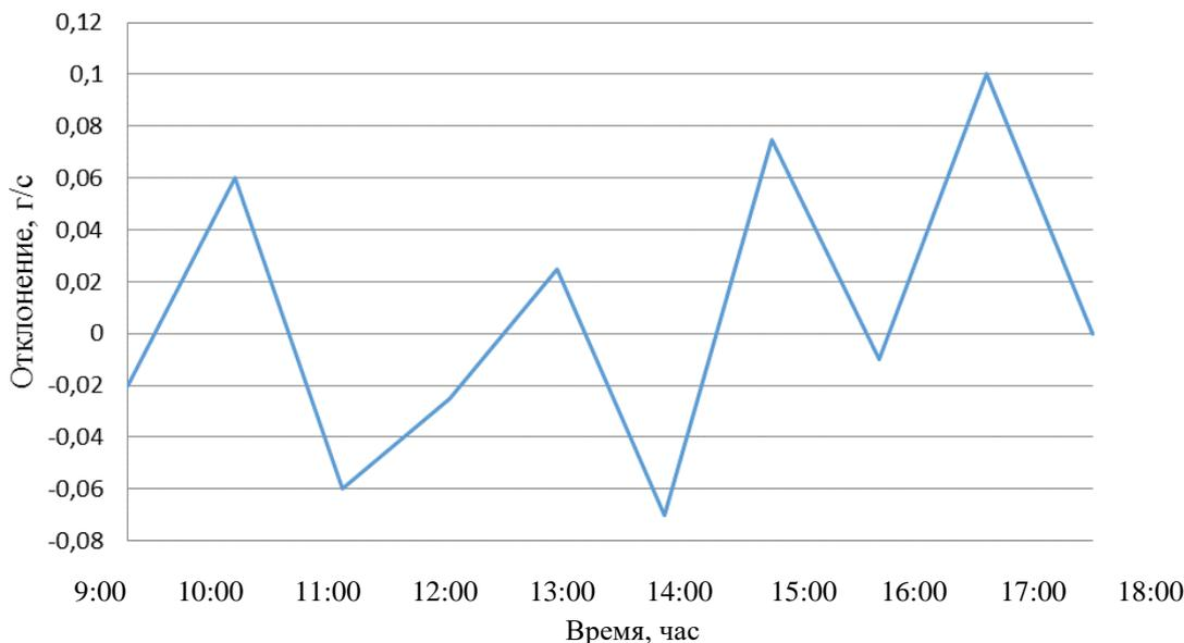
Рис. 1. Отклонение производительности дозатора от среднего значения  $q = 9,92$  г/с при частоте колебаний  $\omega = 314,15$  с<sup>-1</sup> от времени суток
