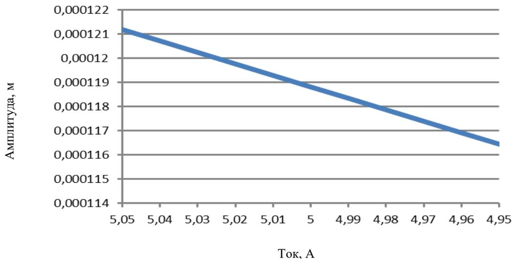
Рис. 3. Изменение амплитуды колебаний в зависимости от тока электромагнита.
