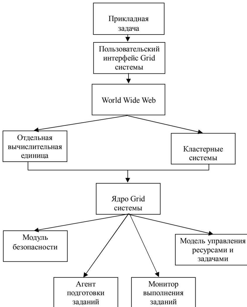
Рис.1. Принцип функционирования Grid-систем
